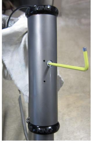
Schraubensicherung auftragen und ebenfalls mit 3Nm festziehen.
