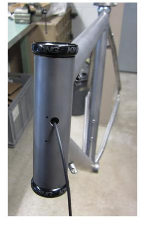
Als nächstes nimmt man nur die Gabel und schiebt sie nach hinten zeigend von unten ins Steuerrohr, bis die Lichtkabelbohrung im Gabelschaft in der Steuerrohrbohrung sichtbar wird. Jetzt kann man von vorne das Ende des Lichtkabels in die Bohrung schieben:
