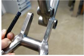
9. Es empfiehlt sich, nach der Montage der Lager einige Stunden zu warten, bevor man das Rad in Betrieb nimmt, damit der Kleber optimal aushärten kann.
