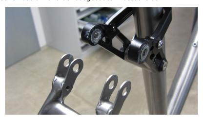
Die Schraube mit dem Mini-Senkkopf verbleibt normalerweise in der Achse, falls sie sich löst, ist sie wieder mit Schraubensicherung zu fixieren (**3Nm**). Der Minisenkkopf zeigt zur Rahmenmitte, die Achse wird also von innen nach aussen gesteckt, wobei es wichtig ist, diese Achse NICHT mit Fügeverbindung zu montieren, sondern mit einem leichten Fettfilm zu versehen. Die beiden M5x10 Senkschrauben mit konischer U-Scheibe aussen werden mit Schraubensicherung auf **3.5Nm** angezogen.
