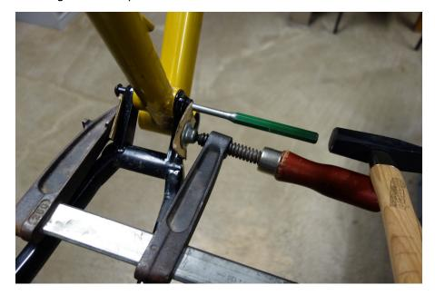
Wenn der Hinterbau komplett demontiert werden muss (z.B. für den Tausch weiterer Lager), die Schraube nochmals soweit hineinstecken, dass der Hinterbau lose am Rahmen fixiert ist. Dies erleichtert den Ausbau der Achsen am Umlenkhebel.
