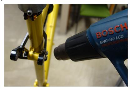
Zuletzt kann nun der Umlenkhebel selbst abgebaut werden. Hierzu muss die gesamte Lagereinheit grosszügig erwärmt werden. Zuerst schraubt man die beiden Inbusschrauben lose. Rahmen ab Mitte 2019 haben hier zwei M5 Schrauben, ältere Rahmen M6! Im nachfolgend geschilderten Auspress-Prozedere werden M5-Schrauben erwähnt, für Rahmen mit M6-Gewinde müssen entsprechend natürlich M6-Schrauben mit gleicher Länge verwendet werden.
