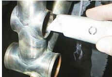
2. Neues Lager mittels Einpresshülse und Werkzeugschraube vollständig auf die Aluachse aufpressen. Das Lager darf nicht über die Aluachse vorstehen! KEINEN Kleber Verwenden.
