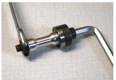
3. Die Lagersitze im Rahmen UND die Aussenseite der Kugellager mit hochfester Fügeverbindung (z.B. Loctite 638) benetzen. (beidseitig benetzen wegen Abstreifeffekt)
