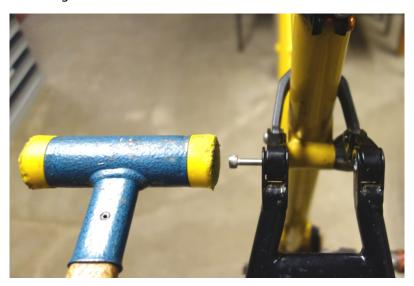
Der Hinterbau lässt sich nun komplett entfernen. Als nächsten Schritt löst man die Schrauben der Dämpferverlängerung. Auch diese Schrauben sind mit Loctite gesichert und sollten vor dem Lösen erwärmt werden (ca. 150 Grad). Wenn beide Schrauben (am linken und rechten Umlenkhebel) gelöst sind, lassen sich die Umlenkhebel nach hinten wegklappen. Vorsicht auch hier sind pro Schraube 3 Passscheiben verbaut (Modelle bis
