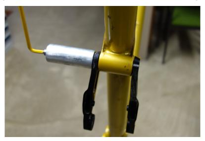
Damit löst sich der gegenüberliegende Umlenkhebel, die 1mm Passcheibe wird ebenfalls entfernt.
