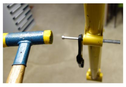
Das (die) noch im Rahmen steckende(n) Kugellager können nun mit dem Durchschlag (d=6mm) sorgfältig ringsum herausgeklopft werden, aufpassen dass die dünnwandige Distanzhülse zwischen den Lagern dabei nicht beschädigt wird.
