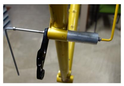
Jetzt wird die Auspresshülse entfernt, und in das weniger überstehende Achsstück wird die M5x60 Schraube ohne Hülse eingeschraubt und mit dem Kunststoffhammer wird nun die Achse komplett herausgeklopft.
