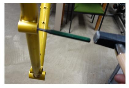
Klebereste mechanisch mit einer Messerklinge entfernen, anschliessend mit Spiritus o.ä. säubern.
