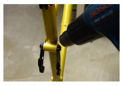
Nachdem beide Schrauben entfernt sind, müssen erst die Gewinde gut von sämtlichen Schraubenkleber-Resten befreit werden, z.B. mit einer Druckluftpistole.
