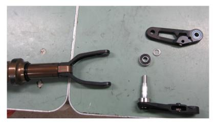
Je nach Toleranzen lässt sich die Achse nun relativ leicht durch das Lager schieben.
