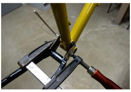
Sobald die Schraube vollständig aus dem Gewinde herausgeschraubt ist (12mm), bewegt sie sich nicht mehr weiter. Jetzt kann man mit einem Durchschlag (d=8mm) die Schraube vorsichtig herausklopfen.
