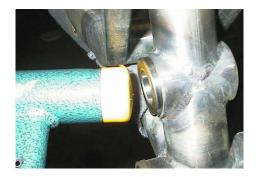
5. Aluachse mit aufgepresstem rechtem Lager von rechts in den Rahmen schieben und mittels Werkzeugschraube und Einpressscheibe auf dem linken Lager festziehen. Wichtig: komplett festziehen, damit das Lager nicht über die Aluachse übersteht.
